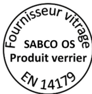
Figure 24 – Exemple de marquage sur le verre
