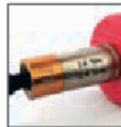
Figure 27 – Tournevis dynamométrique de serrage des cales
