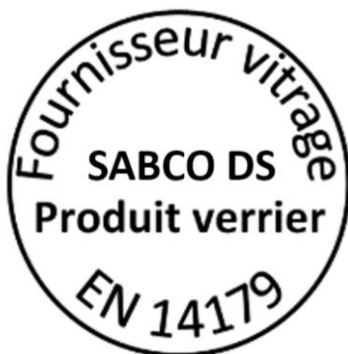
Figure 24 – Exemple de marquage sur le verre
