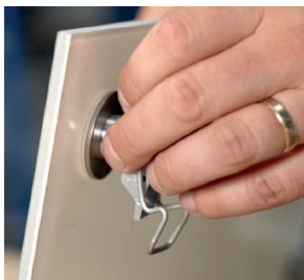
Insérez la bague et la vis dans le trou fraisé du panneau et vissez-les avec le crochet.
