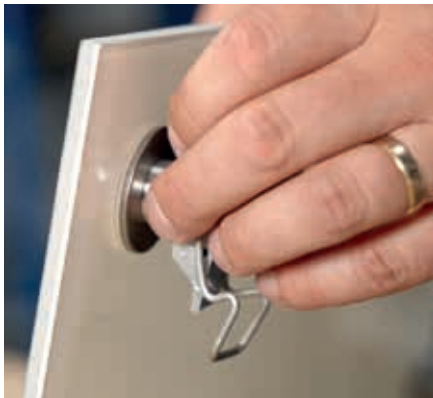
Insérez la bague et la vis dans le trou fraisé du panneau et visez les avec le crochet.
