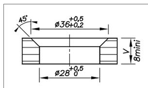
Plano de la perforación cilíndrica
