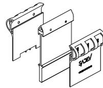
*Il se divise en 3 parties pour vous permettre de démonter les cales du rail avec facilité.*
